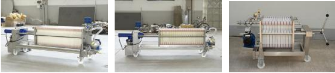
Şekil 2.1. Hidrolik ve manuel kapamalı filtre presler (11).
